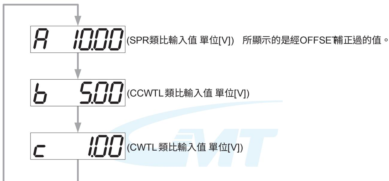
註)超過± 10V 的電壓無法正確顯示。
